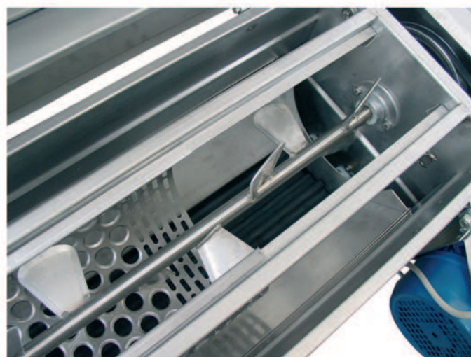
Dettaglio gruppo pigiante Detail of crushing unit Detalle del grupo moledor
