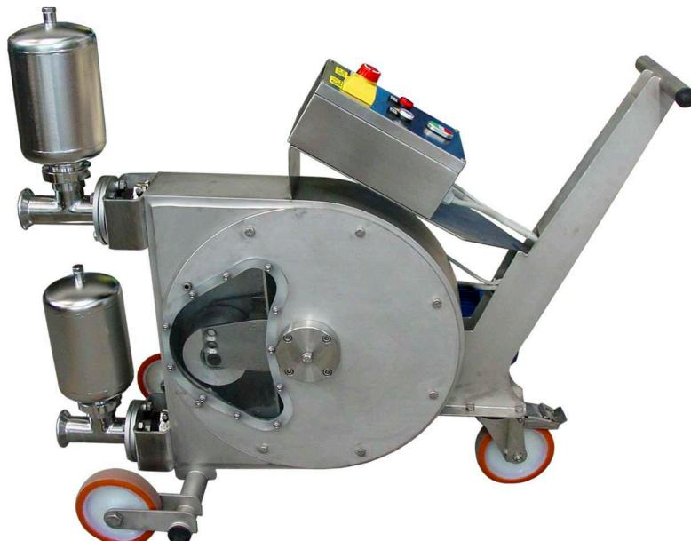
Il principio di funzionamento della pompa peristaltica, come risaputo, garantisce un pompaggio lineare, limitato schiacciamento ed assenza totale di riscaldamento del prodotto travasato.
